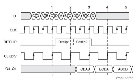
*Figure 8-12:* **Bitslip Timing Diagram**
